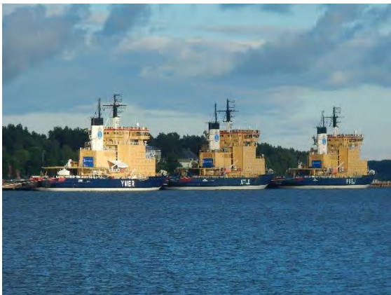
Eisbrecher und Forschungsschiffe in Luleå, bis 22 Personen Besatzung, 24.500 PS, brechen bis zu 1,9 m dickes Eis
